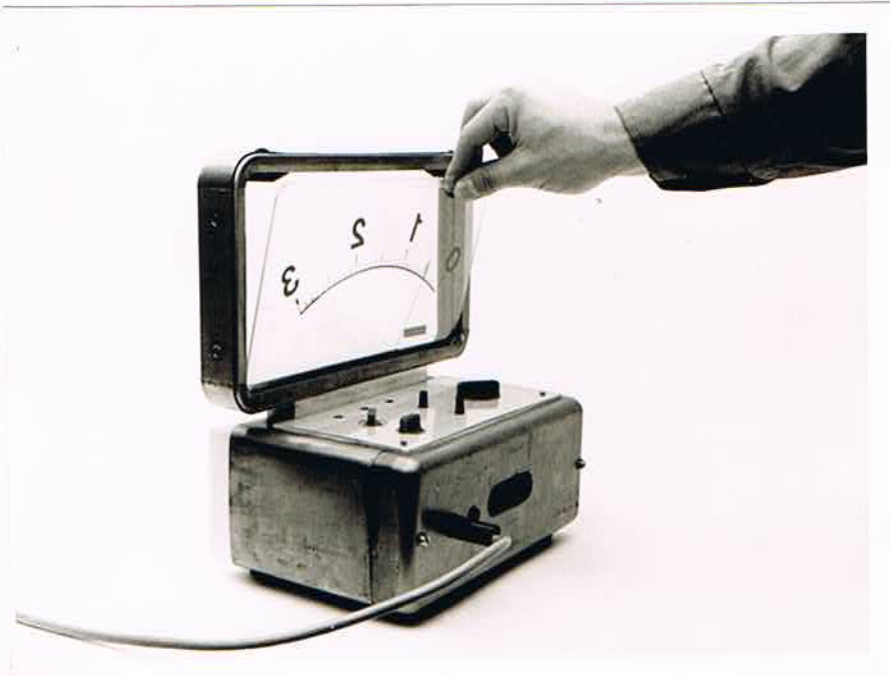
Bild 4. Einsetzen einer der Wechselskalen (12) in den Skalenträger (3)
