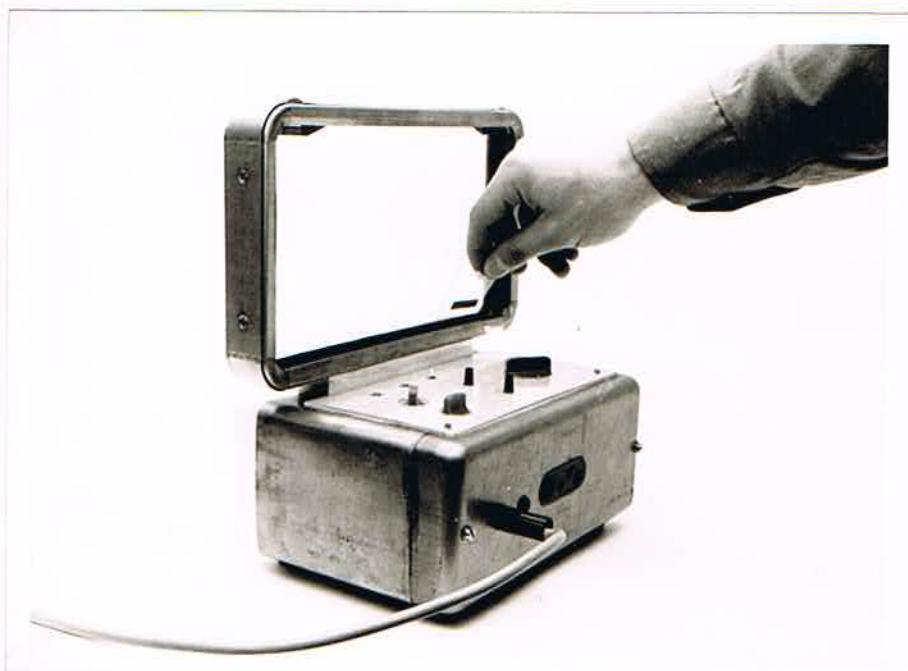
Bild 3. Einsetzen eines Meßvorsatzes in den Skalenträger (3)
